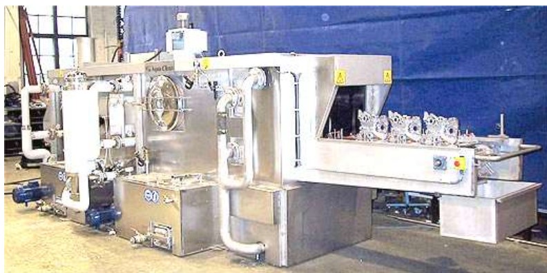
Рисунок 3.10 – Тунельна мийна машина фірми Sampo-Roserwel для очищення вузлів трансмісії
